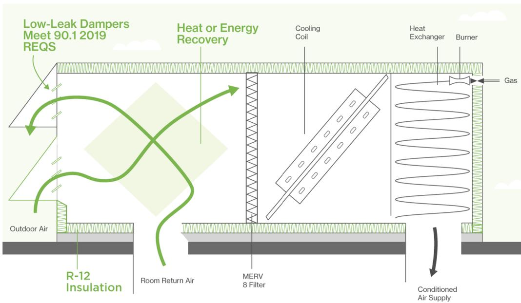
FIGURE 4: TIER 2 ERTU SCHEMATIC DIAGRAM<sup>5</sup>
