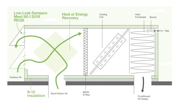
FIGURE 4: TIER 2 ERTU SCHEMATIC DIAGRAM<sup>5</sup>
